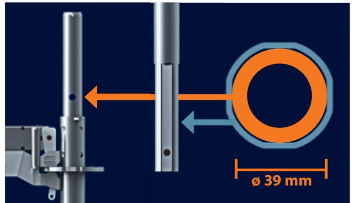
Durch die Standardmaße für Ständer- und Rohrverbinder-Durchmesser ist die Kombination mit herkömmlichen Systemen möglich. Durch die Anpressung der Ständer-Enden erfolgt ein Ausgleich des durch die optimierte, geringere Wandstärke der SUPER-RS-Ständer hervorgerufenen Spiels zwischen Rohrverbinder und Ständerfuß.
