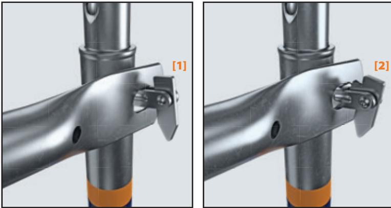
Durch einfachen Kippstifttausch wird aus einem Ständer für ausbaubare Geländer **[1]** ein Ständer für definitive Geländer **[2]**. Nur in Schrägstellung während der Montage/Demontage kann dann das Geländer montiert/demontiert werden. Das Geländer an sich ist für beide Varianten das Gleiche.
