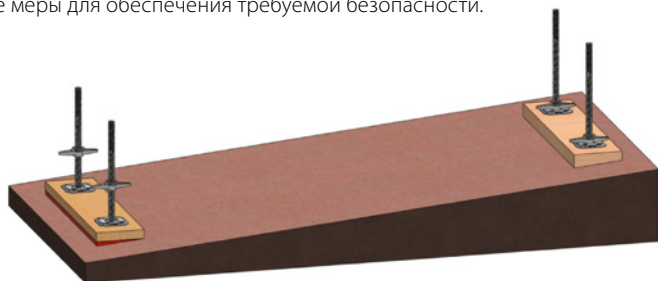
Рис. 2: Подкладки для распределения нагрузки на наклонной поверхности
