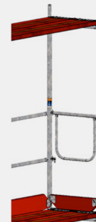
Рис. 33: Торцевые перила установлены, открытый конец трубы насажен на флажковый замок
