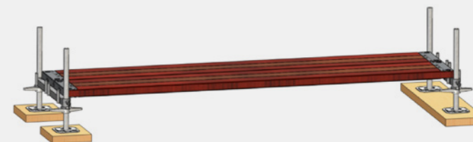
Рис. 4: Системные настилы на поперечинах настила
