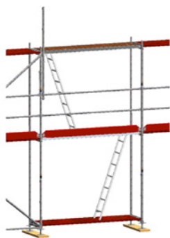
Рис. 26: Монтаж первого столбика МЗП
