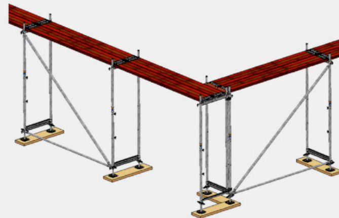
Рис. 18: Формирование угла с двумя вертикальными рамами
