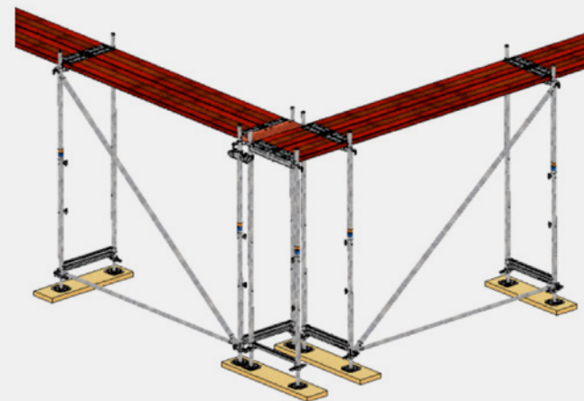
Рис. 19: Формирование угла с тремя вертикальными рамами
