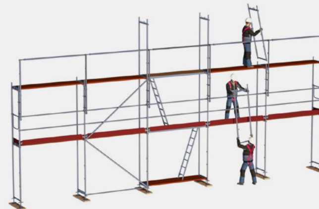
Рис. 25: Пример вертикальной транспортировки вручную
