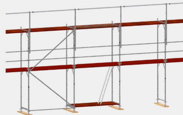
Рис. 29: Монтаж остальных элементов МЗП
