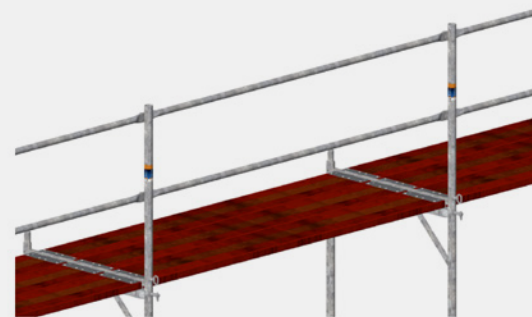
Рис. 44: Верхняя завершающая часть со стойками ограждения и поперечинами
