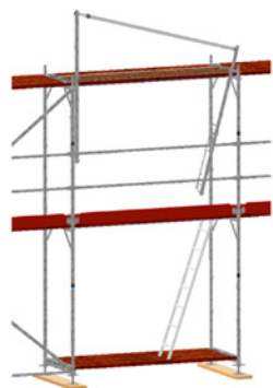
Рис. 27: Установка МЗП и соединение второй стойки МЗП
