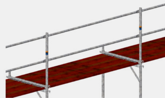
Рис. 45: Верхняя завершающая часть со стойками ограждения и фиксаторами настила
