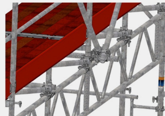
Рис. 57: Присоединение диагоналей с помощью неповоротных хомутов
