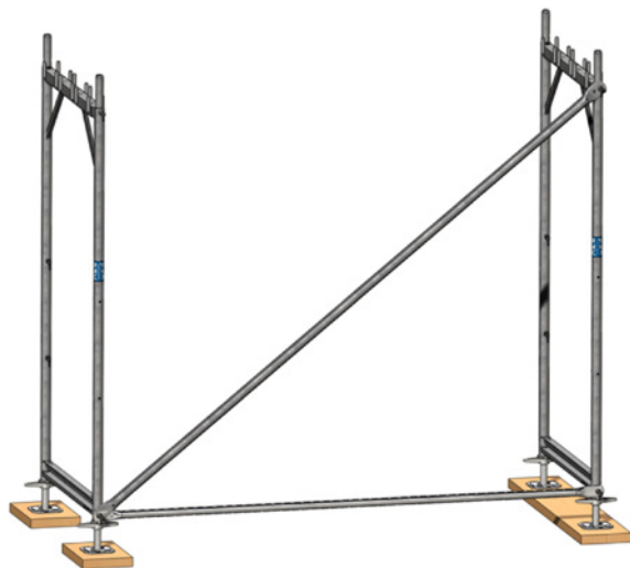
Рис. 13: Монтаж первой секции лесов: вертикальная диагональ
