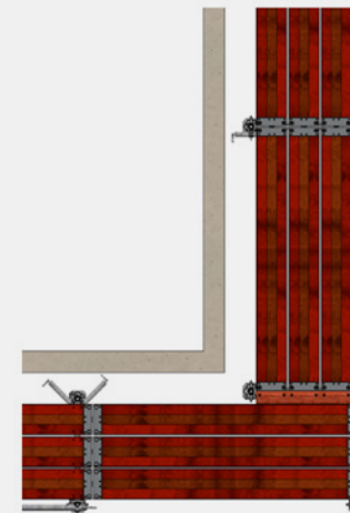
Рис. 41: Анкерные крепления в углах, исполнение с двумя вертикальными рамами
