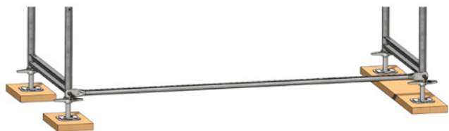
Рис. 7: Монтаж первой секции лесов: продольный ригель
