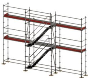
Рис. 7.2. Конфигурация лестницы А
