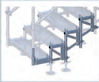
**Flexibel** – dieser sichere und bequeme Gerüstestieg lässt Stufenbreiten zwischen 0,65 m und 3,00 m zu und ist eine interessante Alternative zu systemfreien Lösungen.
