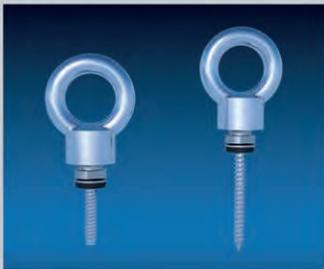
**Komplett** – die Anker bestehen aus der passenden Schraube, der Gewindehülse, einer Dichtscheibe aus Neopren sowie der abschraubbaren Ringmutter.
