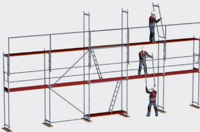
Рис. 25: Пример вертикальной транспортировки вручную
