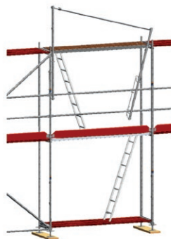
Рис. 27: Установка перил МЗП и соединение второго столбика МЗП
