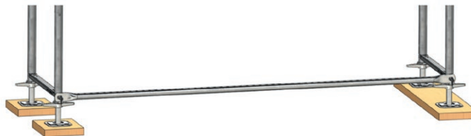
Рис. 7: Монтаж первой секции лесов: продольный ригель
