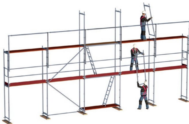
Рис. 30: Монтаж яруса лесов под защитой МЗП
