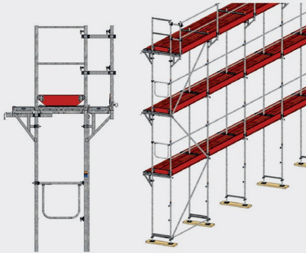
Рис. 51: Леса с наружными и внутренними расширяющими консолями из одной доски
