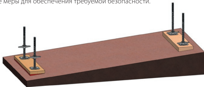
Рис. 2: Подкладки для распределения нагрузки на наклонной поверхности
