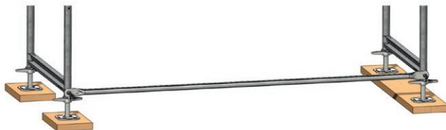
Рис. 7: Монтаж первой секции лесов: продольный ригель
