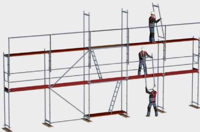
Рис. 25: Пример вертикальной транспортировки вручную
