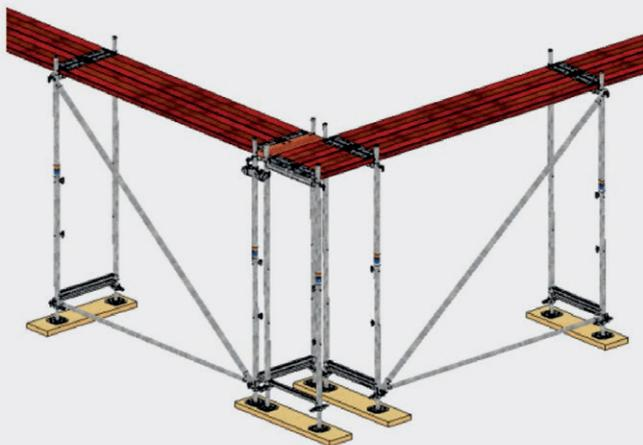
Рис. 19: Формирование угла с тремя вертикальными рамами
