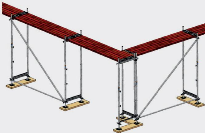
Рис. 18: Формирование угла с двумя вертикальными рамами
