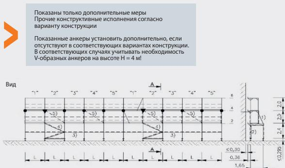
• Стандартный анкер: кронштейн для крепления лесов фиксируется только на внутренней стойке
