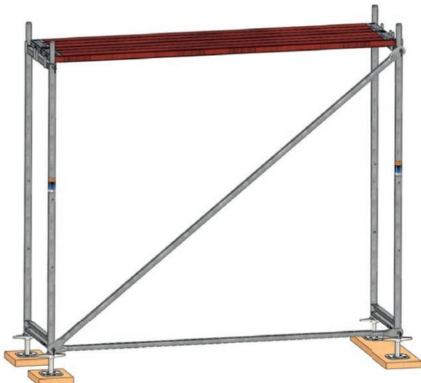
Рис. 16: Полностью смонтированная первая секция лесов
