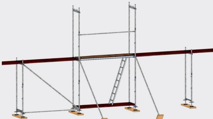
Рис. 20: Пример временной защиты от опрокидывания первого яруса лесов
