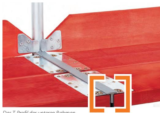
Das T-Profil der unteren Rahmen-traverse – hier im Schnitt. Jede neue Gerüstlage sichert automatisch die Beläge, Abhub unmöglich.
