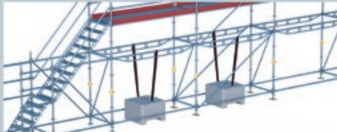
**Praktisch** – durch zahlreiche Anschluss- und Anbaumöglichkeiten können Blocker jeder Gerüstsituation angepasst werden – stapleroptimiert. Blocker haben ein Gewicht von
