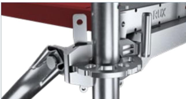
**Unsere Power-Diagonale aus dem bewährten RINGSCAFF-System** sorgt mittels Keilkopf für kraftschlüssige Knotenverbindungen auf Belagebene. Stabiler geht nicht. Außerdem wird dadurch die selbstausrichtende Montage gewährleistet, das heißt: Einmal die Grundriegel nivelliert, bleibt das Gerüst automatisch rechtwinklig. Lage für Lage wackelt da nix.
