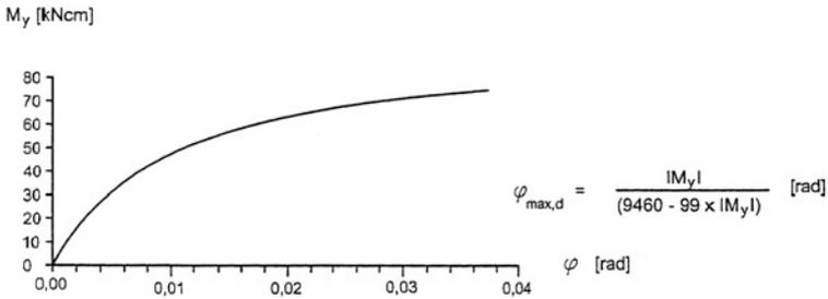
Bild 5: Minimale Drehfedersteifigkeit
