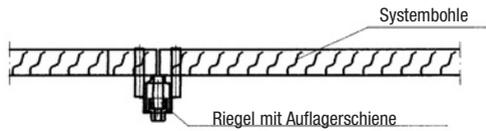
Belag aus Systembohlen mit Rohrauflage (Bild 3-9)
