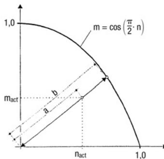
Bild 1 Vektorellen Ausnutzungsgrad im Ständerrohr
