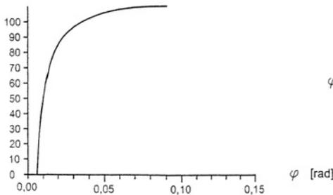
Bild 3: Maximale Drehfedersteifigkeit
