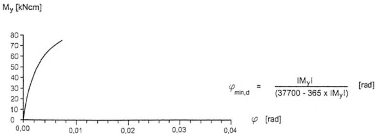
Bild 6: Maximale Drehfedersteifigkeit
