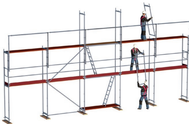
Bild 30: Montage der Gerüstlage im Schutze des MSG.
