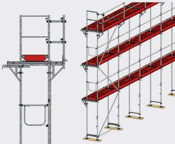
Bild 51: Gerüst mit einbohliger Verbreiterungskonsolen außen und innen
