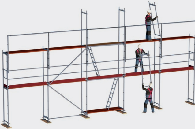
Bild 25: Beispiel für den Vertikaltransport von Hand.
