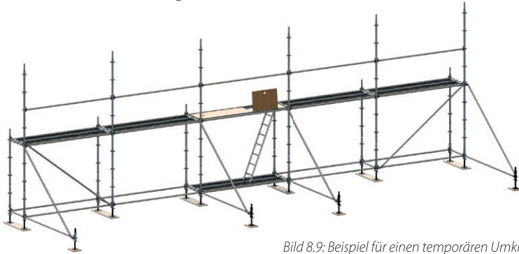
Bild 8.9: Beispiel für einen temporären Umkippschutz
