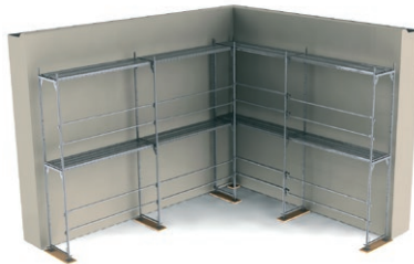
Abbildung 8.1b: Grundgerüst - Einrüstung Fassadeninnenecke
