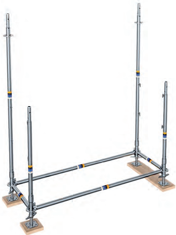
Bild 21 Lochscheiben der RINGSCAFF-Anfangsstücke verbinden Belag- / Längsriegel
