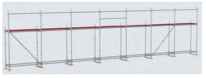
Bild 24 Gerüstfelder der 1. Ebene
