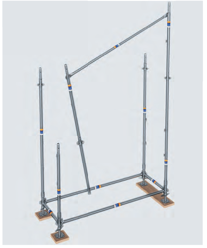
Bild 28 1 Außenständer 2,00 m mit Geländer aufgesteckt, 1 Außenständer 2,00 m mit Geländer auf Kippstift
