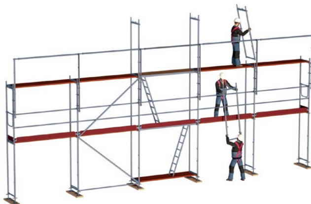
Bild 30: Montage der Gerüstlage im Schutze des MSG.
