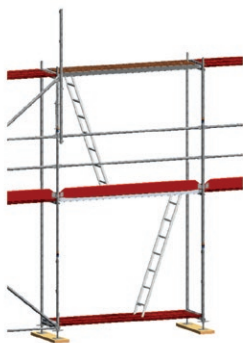
Bild 26: Montage des ersten MSG-Pfostens.
