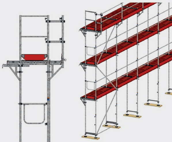
Bild 51: Gerüst mit einbohliger Verbreiterungskonsolen außen und innen
