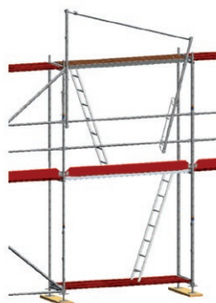
Bild 27: Einhängen des MSG-Geländers und zweiten MSG-Pfostens koppeln.
