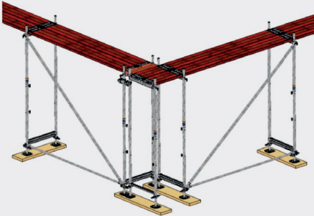
Bild 19: ECKAUSBILDUNG mit drei Vertikalrahmen
