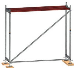
Bild 15: Systembeläge in die Zapfen eingehängt
