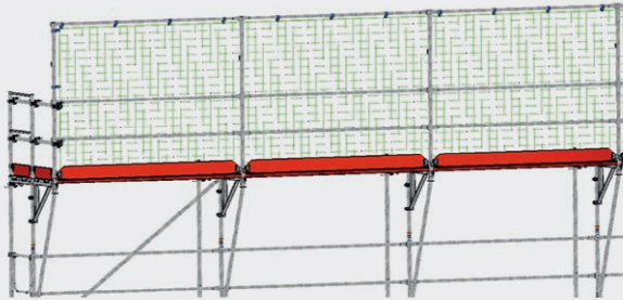
Bild 61: Schutzwand auf Verbreiterungskonsolen
